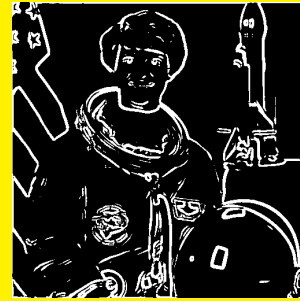
FIGURE 7 – Les contours après floutage, filtre de Sobel et seuillage à 140
